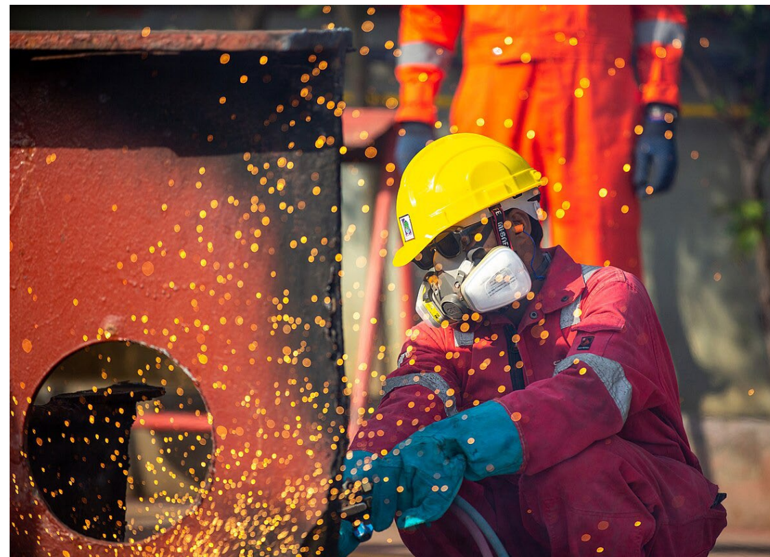
Skjæring av resirkulert fartøysskrog ved hjelp av gasskutter i Hong Kong Konvensjonen-kompatibelt verft i India. Foto: Nayeem Noor.
