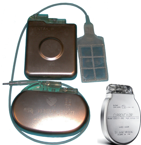
Figur 1. Utvikling av ICD'er. Øverst den første ICD'en frigjort for salg, bildet viser første ICD lagt inn i Norge (Ullevål) 1984. Vekt 289 g, 150 cc, 22 mm tykk. Under denne en bedre formet Ventak, med endokardiell elektrode, men fremdeles for plassering på abdomen. Til høyre en moderne ICD, SJM Current. Vekt 80 g, 42 cc, 14 mm tykk.
